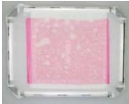
Para acelerar el proceso de revelado con agua, se puede agregar al chorro de agua, aire comprimido que facilitará la expulsión de las partículas de emulsión no expuestas.
